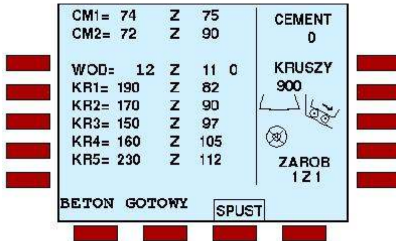
Ekran spustu betonu
